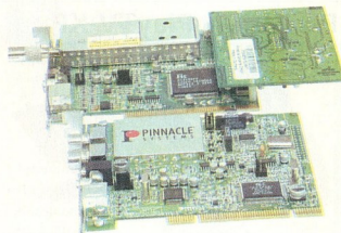
A két kártya teljesen kompatibilis egymással: alul a PCTV legfrissebb változata, felül pedig az ötéves testvér
