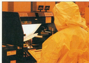
Vizuális vizsgálóállomás segítségével szűrik ki az esetleges hibákat az Itanium2 processzormagokat tartalmazó szilíciumszelvényen
