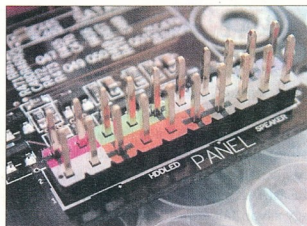
Az előlapi panel vezetékének a csatlakoztatása
