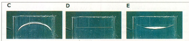
A 3 mm átmérőjű lencse alakváltása a rákapcsolt feszültség hatására
