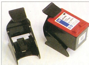
Vagy a nyomtatóhoz, vagy a tintapatronhoz kapjuk a patron tárolására szolgáló keretet (HP DeskJet 5850)
