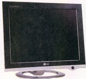
A képpontok beállási sebessége (reakció- vagy válaszidője) az LG L1720P-nél figyelemre méltó: 16 ms.
