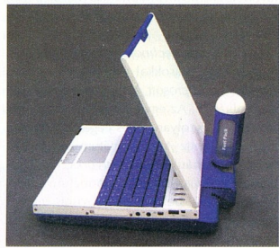
A japán NEC noteszgéphez csatlakoztatható üzemenyagcellájának prototípusa
