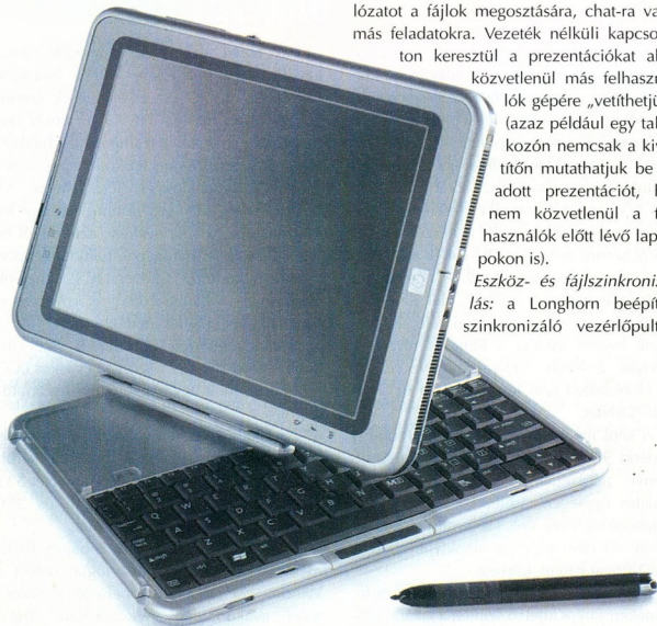
A HP praktikus megoldása: a billentyűzet és a kijelző egy mozdulattal különválasztható (TC1100)
