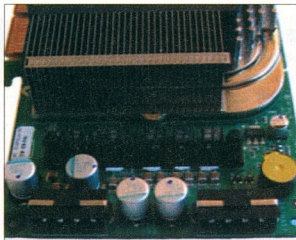
A kártya és az IC gigantikus áramigényű. A kártya kerekén 95 wattnyi csúcsteljesítményt vesz fel a két meghajtó-csatlakozásból és az alaplappól
