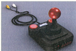
A C64 DTV – alakja ellenére – egy komplett játékkonzol, amelyet közvetlenül a tévékészülékhez köthetünk
