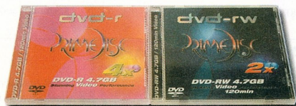
Az első írható és újrairható DVD-lemezek a kötőjeles szabvány égisze alatt készültek
