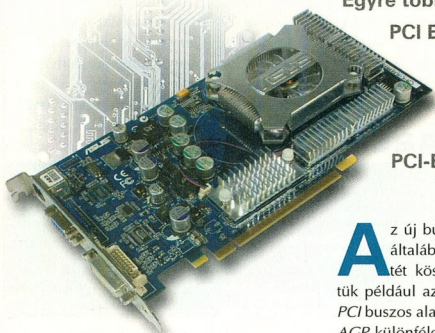
Íme egy natív AGP 8X GPU: a HSI áramkör az élszatlakozó fölött lévő hűtőborda alatt rejlik
