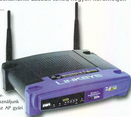
Linksys WRT54G: rádiós hozzáférési pont (AP) tűzfalal felvértezett routerrel kombinálva
