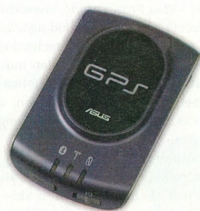
Az ASUS GPS-modulja Bluetooth-szal kapcsolódik a PDA-hoz
