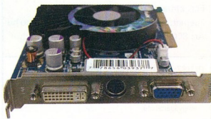
A modern kártyákon több kimenet is található (balról: DVI, S-Video/kompozit, D-Sub)
