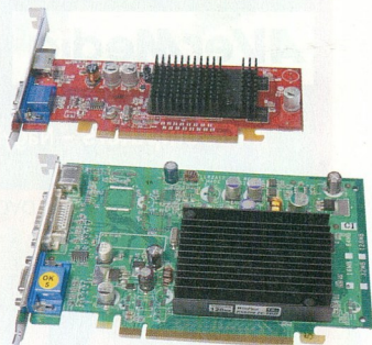
A videokártyák esetében is előny a passzív hűtés
