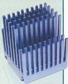
A Zalman kínálatában még az északi hídra szerelhető bords is akad
