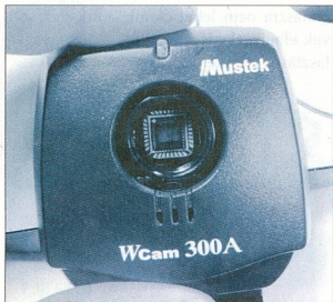
A kamerák lelke az apró CMOS lapka
