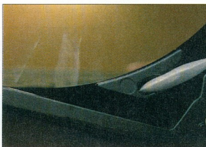
A belső erősítő a túlfeszültségtől elfüstöl, füstje a lemeze rakódik
