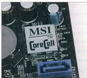
Az órajelek és feszültségek beállítását az MSI alaplapjain a CoreCell chip végzi
