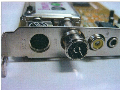
Egy tunerkártyán minden fontos csatlakozás megtalálható
