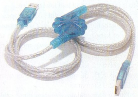
A kábel közepén lévő dobozka jelzi, hogy ez az USB-kábel PC-k összekötésére való
