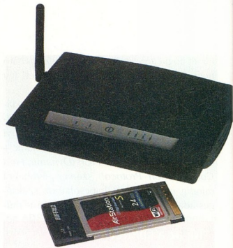
A WLAN routeren mindig van antenna, a notebookba való PCMCIA WLAN kártyákban ez többnyire beépített
