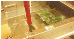
A keret eltávolításával nemcsak a meghajtókat, hanem más alkatrészeket is könnyebben beszerelhetünk
