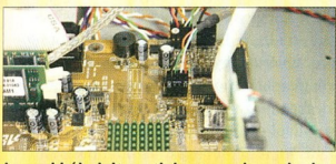
A panel kábeleit csatlakoztassuk az alaplap megfelelő tuskéire (USB, SATA, esetleg FireWire)
