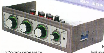
A panel kábeleit csatlakoztassuk az alaplap megfelelő tuskéire (USB, SATA, esetleg FireWire)
