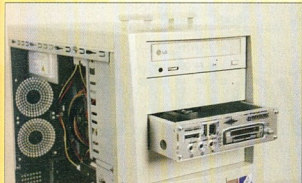
Az oldallap és az előlapi takaró műanyag eltávolítása után a panelt csúsztassuk finoman, de határozottan a házba
