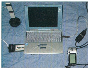
A WLAN hálózatok lehallgatásához egy notebook, WLAN kártya nagyobb antennával, és GPS kell – no meg egy-két jó szoftver
