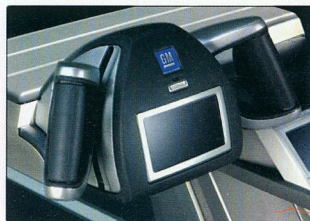
ENNYI A HY-WIRE ÖSSZES IRÁNYÍTÁSA, PEDÁLOK SINCSENEK
