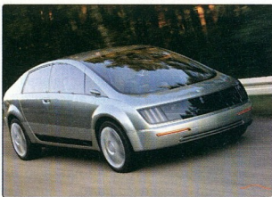
A HY-WIRE KOCSI EGÉSZ KAROSSZÉRIÁJA EGY PERC ALATT LEEMELHETŐ AZ ALVÁZRÓL
