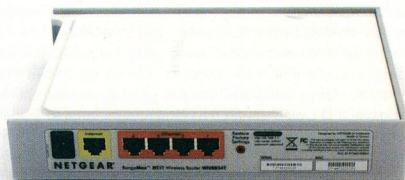
A ROUTER TELJESEN SZOKVÁNYOS CSATLAKOZÓIN SEMMI NEM UTAL, HOGY A LAN CSATLAKOZÓK BIZONY MÁR GIGABITESEK (NETGEAR RANGEMAX NEXT)
