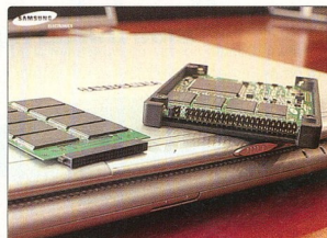
SSD-MEGHAJTÓ A SAMSUNG TŐL: 2,5"-OS, KIZÁRÓLAG NAND-LAPKÁKBÓL ÁLLÓ, MAXIMÁLISAN 16 GB TÁROLÓKAPACITÁSÚ „ALTERNATÍV” MEREVLEMEZ
