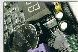
ÁLTALÁBAN AZ ELEM KÖZELÉBEN TALÁLJUK A CLEAR CMOS JUMPERT
