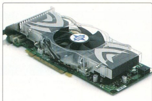
ELŐFORDULHAT, HOGY A HŰTŐ MIATT A VGA KÁRTYA MELLETTI SLOT NEM HASZNÁLHATÓ
