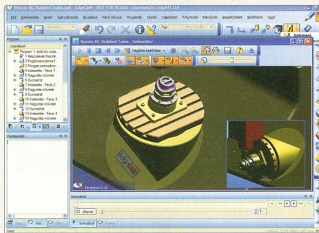
Öttagos megmunkálás szög bezáró forgótengelyű gépen az EdgeCAM-mel
