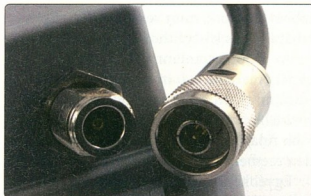
Nagy teljesítményű, kültéri antennák gyakran Type N csatlakozóval illeszthetők a hozzáférési ponthoz
