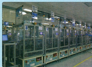
A patronok specializált, automata gyártó-sorokon, tisztatérben készülnek
