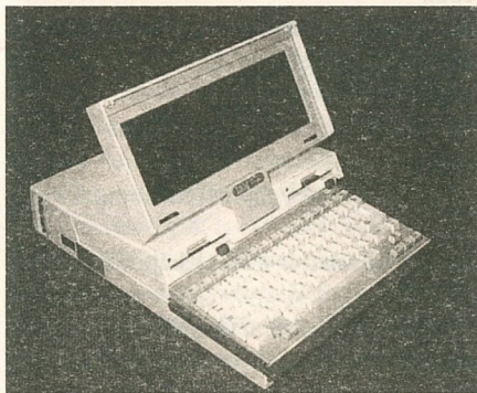
Az IBM PC Convertible kagylószerűen szétnyíló formájával követendő trendet teremtett
