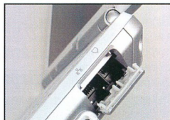
A használaton kívüli csatlakozók apró, porbiztos ajtók mögött tűnnek el
