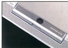
A Sony Vaio elforgatható VGA kameráját a kijelző peremébe építették be
