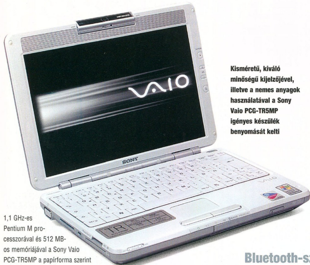
A Sony Vaio elforgatható VGA kameráját a kijelző peremébe építették be
