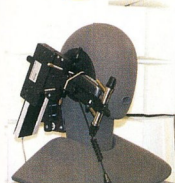
A telefonok elektroakusztikai tulajdonságait egy másik bábu segítségével vizsgáljuk
