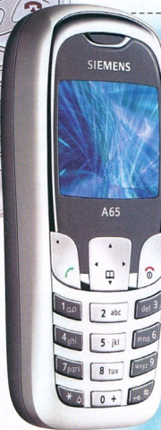
Fapados: a Németországban gyártott A65-ös készülékben 4096 színárnyalattal kijelző található
