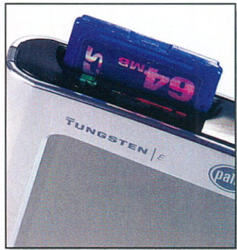
Több tárhely: a legegyszerűbb PDA-k memóriája is bővíthető valamilyen kártyával – a képen a PalmOne Tungsten E SD kártyahelye látható
