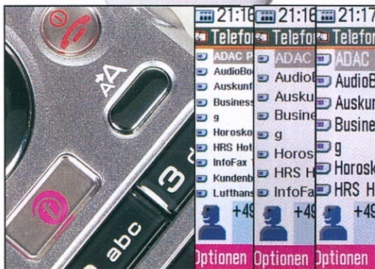
Praktikus: egy speciális gombbal (balra) a TM200-as használója három különböző betűméretet is beállíthat. Így a QVGA kijelzőt minden szituációban jól használhatjuk
