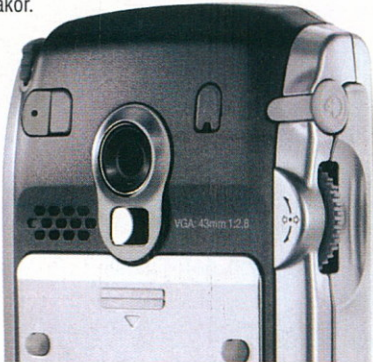
Minitűkőr, lencse, hangszóró és antennacsatlakozó: nem sok szabad hely van a P910i hátoldalán
