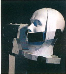
Az adóteljesítményt egy speciális helységben, tesztbábuval mérjük
