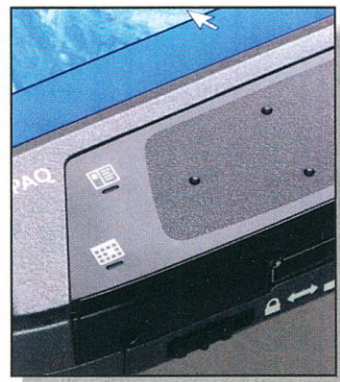
Praktikus: a HP gép tapipadja egyszerre szolgál navigálásra és gyorsindító gombként, leegyszerősítve a PDA kezelését
