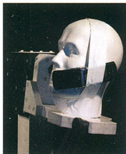
Az adóteljesítményt egy speciális helyiségben, tesztbábuval mérjük
