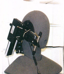
A telefonok elektroakusztikai tulajdonságait egy másik bábu segítségével vizsgáljuk
