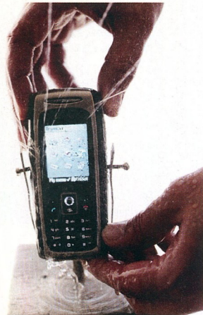
Minden vízbe mártott test: a vízzel 10 percen át lespriccelt – nem csak vízálló – készüléknek a teszt után is működőképesnek kell lennie
