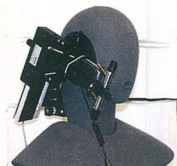
A telefonok elektroakusztikai tulajdonságait egy másik bábu segítségével vizsgáljuk
