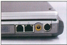
A töltő csatlakozója a szokásostól eltérően a gép oldalára került
