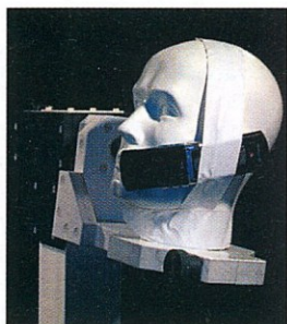
Az adóteljesítményt egy speciális helységben, tesztbábuval mérjük
