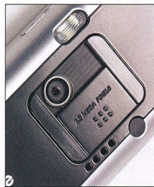
Zárható: a V600i lencsét egy elhúzható műanyag lap védi a portól és a piszoktól
