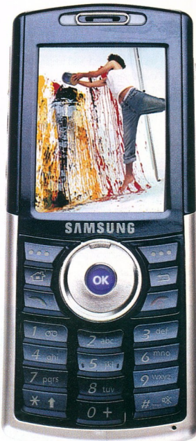
Irányítókerek: a kerek navigációs billentyű forgathatók, illetve meg is nyomhatjuk
