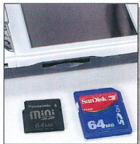
Kettős játék: a HP iPAQ hw6515-nek két memóriakártya-foglalata van – egy az SD és egy a Mini SD moduloknak
