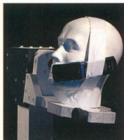
Az adóteljesítményt egy speciális helységben, tesztbábuval mérjük
