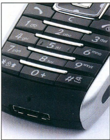
Vakon gépelni: a középső billentyűk mélyebben vannak a többinél
