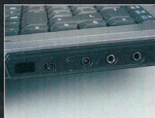
Megosztott feladatot a fülhallgató-kimenetet használhatjuk S/PDIF-ként, ekkor digitális audiojeleket továbbít
