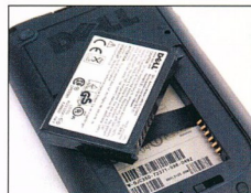
Példás: az akkumulátor könnyedén kicserélhető egy erőteljesebb típusra
