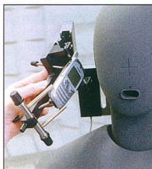
Kísérleti nyúl: a tesztbábu mellett fény derül a mobil elektroakusztikai tulajdonságaira
