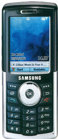
Tiszteletet parancsoló méret: a beépített merevlemez miatt nagyobb készülékházat kellett tervezni
