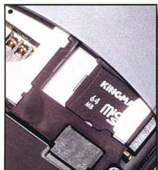
Fontos újítás: az akkufedél alatt MicroSD kártyahelyet találunk. Az alapsomag egy 64 megabájtos kártyát tartalmaz
