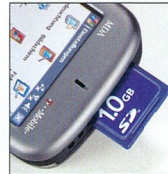
Kvázi szabvány: az SD kártya csatlakoztatási lehetőség zökkenőmentes kompatibilitást biztosít fényképezőgépekhez és MP3 lejátszóhoz egyaránt
