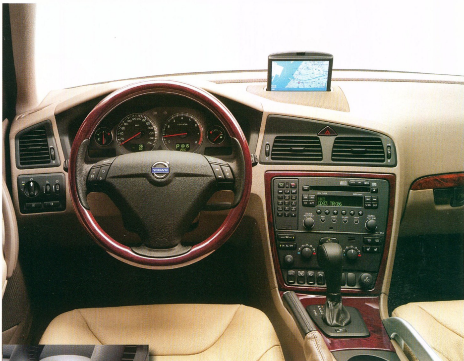
A kormányon a fedélzeti számítógép, a telefon, és a hifi gombja elől, hátul pedig a navigáció kezelő szervei.
