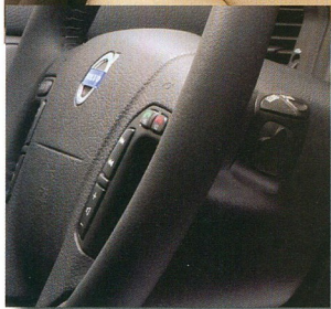
A kormányon a fedélzeti számítógép, a telefon, és a hifi gombja elől, hátul pedig a navigáció kezelő szervei.
