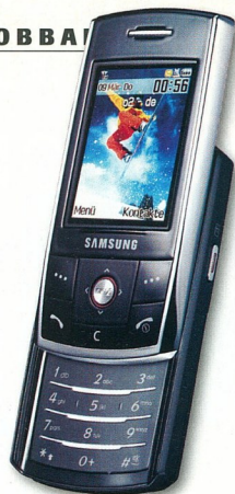
Láthatatlan gombok: a sima felület alatt mechanikus, biztos nyomáspontú gombok rejlenek
