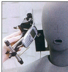
Kísérelti nyúl: a tesztbábu mellett fény derül a mobil elektroakusztikai tulajdonságaira
