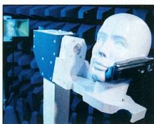
Precíz: bábu segítségével méri a tényleges sugárzási teljesítményt, a sugárzási érték alapját
