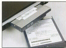
Praktikus: ha előtérbe kerül a hosszú üzemidő, a DVD-meghajtót pótkumulátorra cserélhetjük
