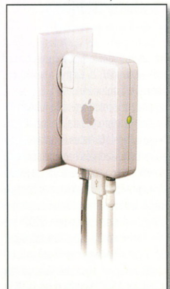
Hordozható WLAN-adapter: az Ethernet-aljzatra kapcsolt Apple Airport Expresszel a levegőbe szórhatjuk az internetet
