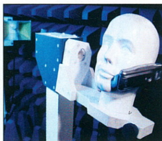
Precíz: bábu segítségével mérik a tényleges sugárzási teljesítményt, a sugárzási érték alapját
