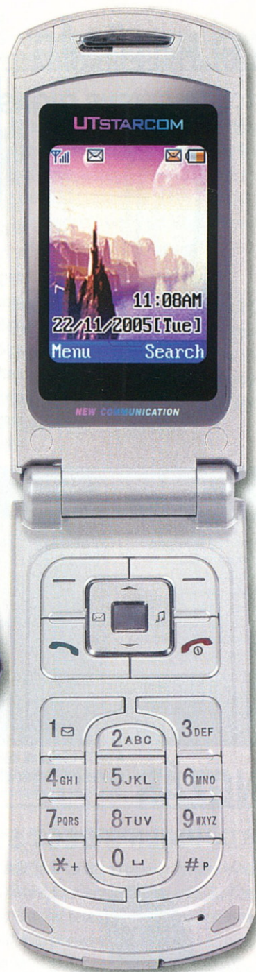
A látszat csal: az F3000 külsőre úgy néz ki, mint egy mobiltelefon, de nincs benne GSM-modul
