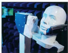
Precíz: bábu segítségével mérik a tényleges sugárzási teljesítményt, a sugárzási érték alapját
