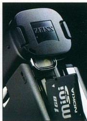
Erejtve: az objektív (letakarva) alatt található a miniSD kártyahely
