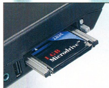
Zökkenőmentes átmenet: a régebbi bővíthetőségi kártyákat a PC Card nyílás fogadja, az újabbakat az alatta levő ExpressCard
