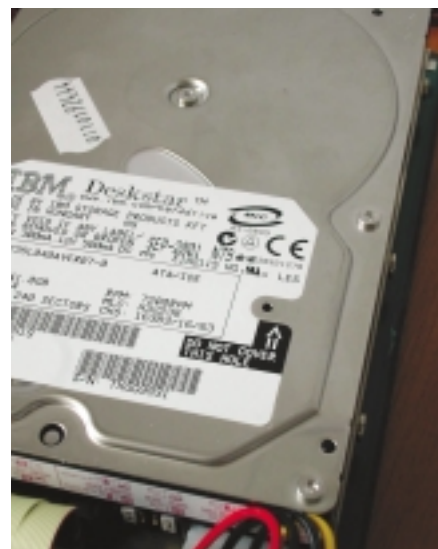
Feltűnően jelölt lélegzőnyílás egy IBM meghajtón. Ha letakarjuk, megfulladhat!
