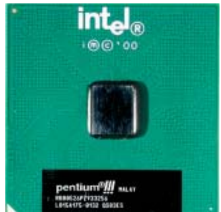
Pentium III processzor, FC-PGA tokozásban. 933 MHz-es frekvencia, 256 KB L2 gyorsítótár
