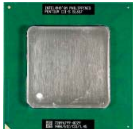
Még az 1,5 GHz-es Pentium 4-nél is gyorsabb: 1,4 GHz-es Tualatin P3, 512 KB L2 cache-sel. Jól látható, hogy erre a processzorra is tettek IHS-t, amely védi a magot, és segít leadni a hőt
