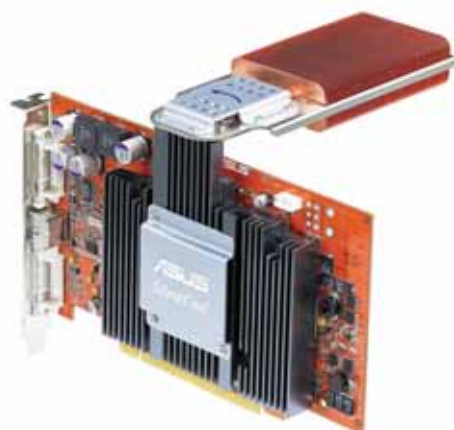
A lamellák elforgathatók a kritikus komponensek közeléből
