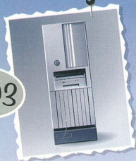
Zanza Serv 5 DVX szerver 1x40 MHz CPU, 64 MB RAM
