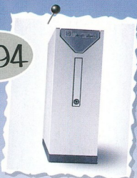
PIConnect A-10 DTV szerver 2x66 MHz CPU, 96 MB RAM
