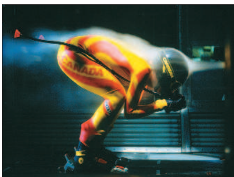
1. kép A kanadai sícsapat tagja 2m x 3m-es szélcsatornában
