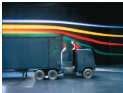
2. kép Jármű vizsgálata 2m x 3m-es szélcsatornában
