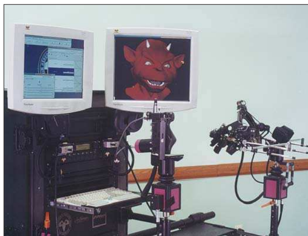
Álvtányra szerelt HDPS összeállítás háromdimenziós, számítógépes karakterekhez – látható a kézi vezérlés, a grafikus felület és a nézegető
